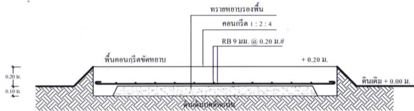
รูปตัดขยายฐานรองถังกรองสนิมเหล็ก มาตราส่วน 1 : 25
